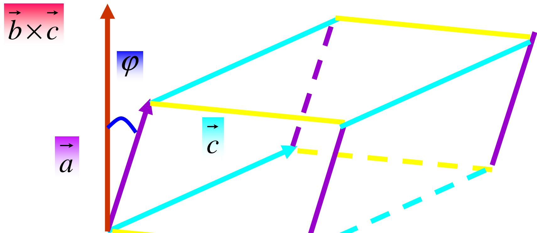
六面體體積  $V = |(\vec{a}, \vec{b}, \vec{c})| = \begin{vmatrix} \vec{a}_x & \vec{a}_y & \vec{a}_z \\ \vec{b}_x & \vec{b}_y & \vec{b}_z \\ \vec{c}_x & \vec{c}_y & \vec{c}_z \end{vmatrix}$  的絕對值
